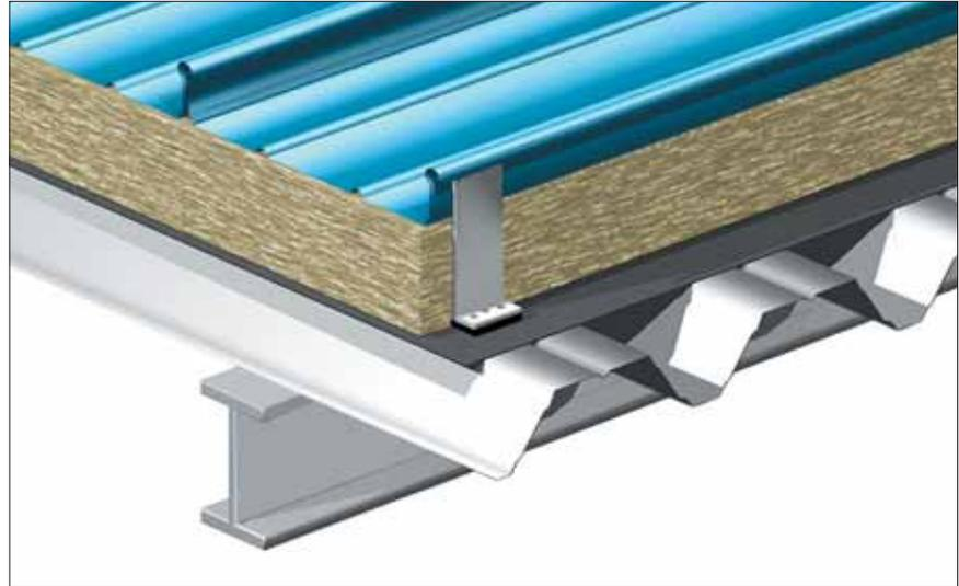
Le schéma de disposition des pattes de fixation doit si possible permettre une charge homogène des bacs en acier tant pour des surcharges (neige) que pour des charges de soulèvement (dépression par le vent).
