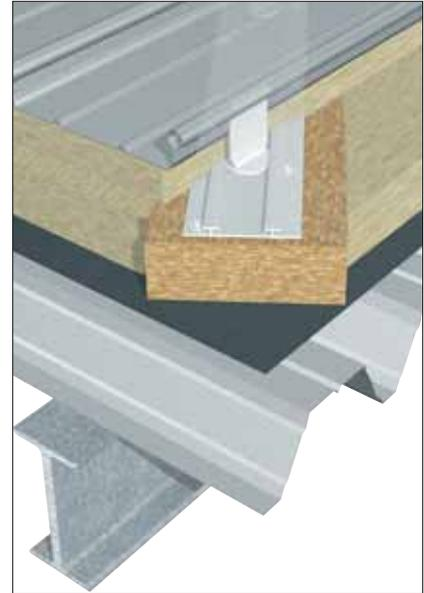
Les pattes spéciales de fixation DuoPlus sont introduites dans les rails puis tournées de sorte qu'elles soient parallèles aux bourrelets des bacs (angle minimum de rotation = 45°).
