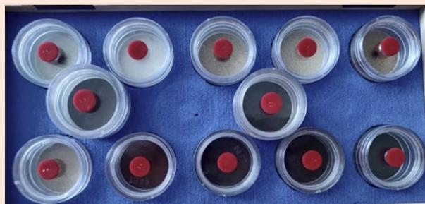
Échantillons d'un test réalisé dans un atelier révélant divers niveaux de concentration de poussière selon les postes.
