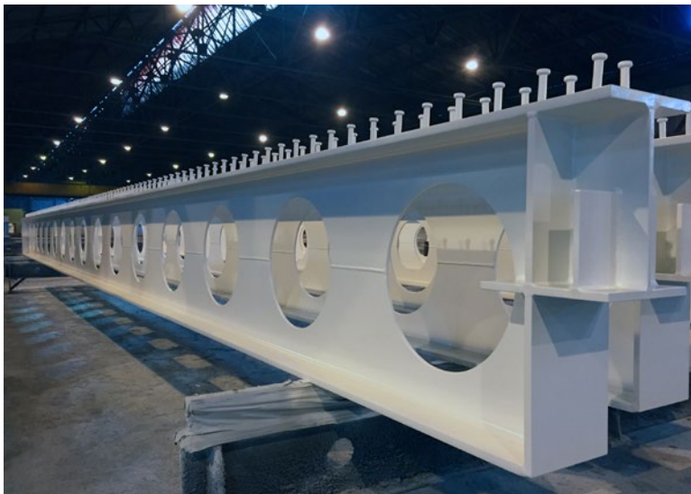
Figure 124 : Poutre cellulaire mixte dans l'atelier de fabrication, après parachèvement
