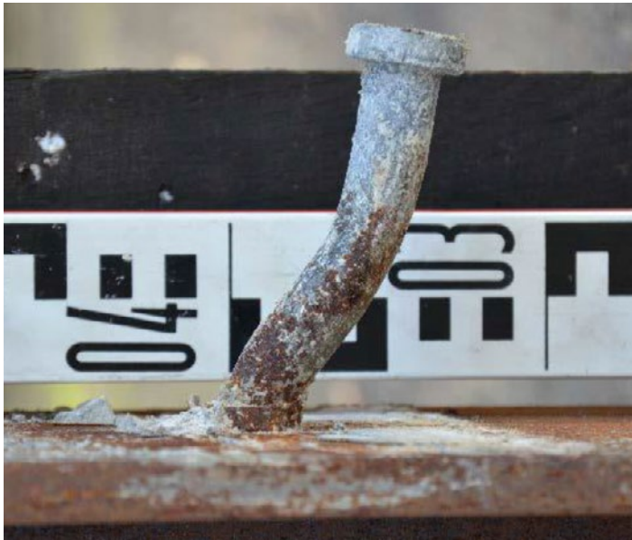
Figure 102: Mode de ruine d'un goujon soudé après essai
