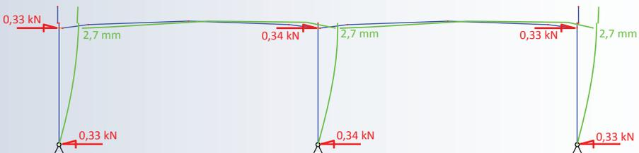
**Figure 49** : Cas fictif unitaire – Chargement et déformation
