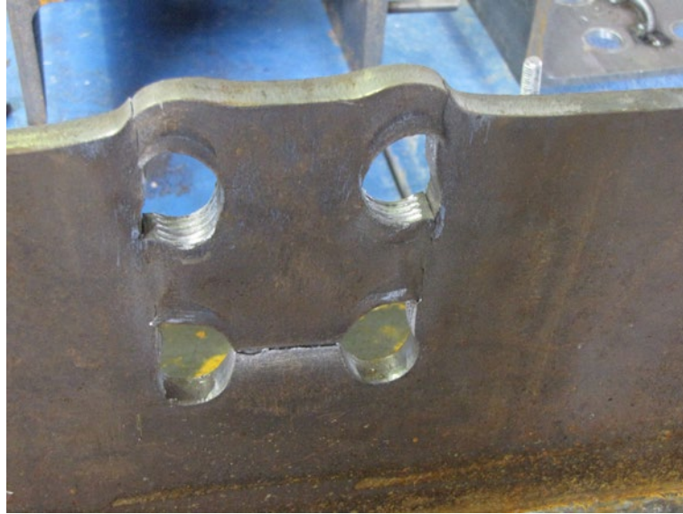
Figure 119: Ruine d'un gousset en cisaillement de bloc
