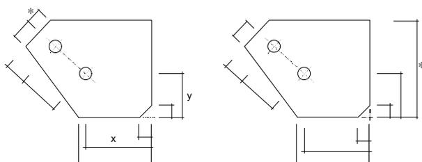
Cotation du gousset : cote de trusquinage et hauteur ou pince transversale (\*).
