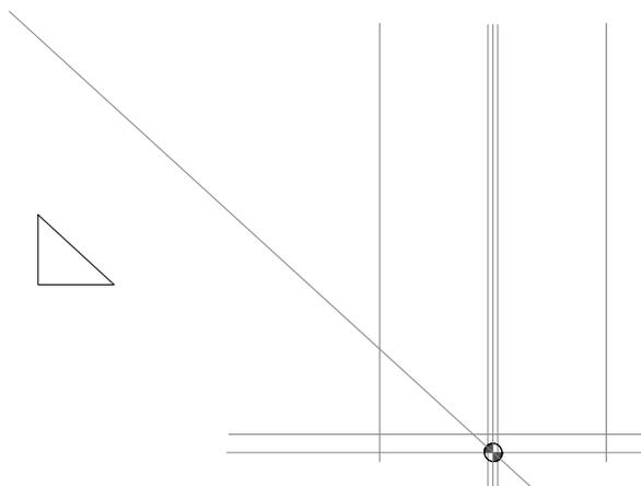
Référence / épaisseur de platine / axe neutre du poteau / âme / semelle / triangle de pente / point d'épure / axe neutre de cornière.
