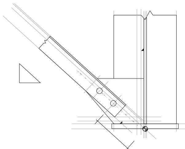
Gousset / perçages / platine / poteau / cotation du boulon de tête au point d'épure
