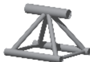
Principe d'assemblage d'une poutre triangulaire en tubes.
