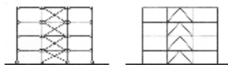
Exemples de palées de stabilité triangulées : contreventement en X par diagonales rigides (à gauche) ; ossature contreventée à nœuds rigides (à droite).
