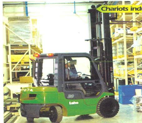
Conçus pour les besoins industriels ou semi-industriels, ils sont disponibles en énergie électrique sur batteries, diesel ou gaz et leur capacité de charge est de 1 à 7 tonnes. La capacité de levage de chaque appareil varie en fonction de la surface de la palette et de la hauteur de levage. Il convient de se référer à l'abaque de charge apposé sur chaque appareil.
