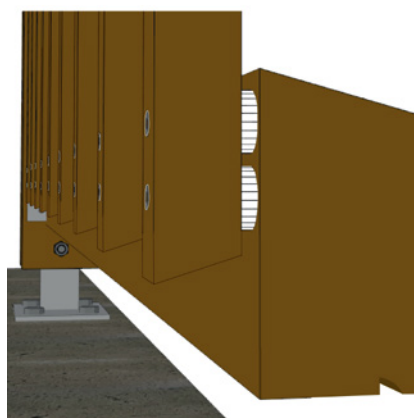
Figure 46 – Extrémités inférieures des barreaux sur traverse basse
