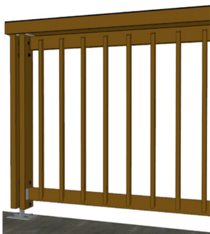
Figure 44 – Barreaux en applique sur les traverses
