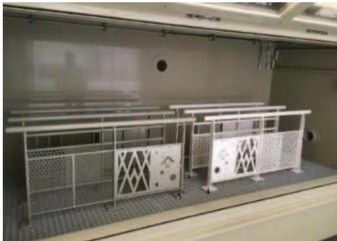
**L'élaboration d'un programme d'essais en corrosion accélérée sous cycles alternés, visant les protections et les dispositions constructives appliquées sur les maquettes issues des éléments complexes de métallerie préalablement définis.**
