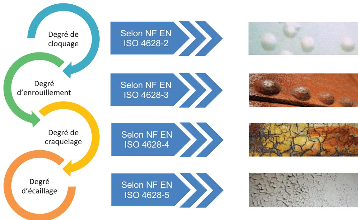
Les divers contrôles réalisés selon les normes NF EN ISO 4628 (degré de cloquage, d'enrouillement, de craquelage, d'écaillage, largeur de décollement et de corrosion) permettent de caractériser la qualité du revêtement.
