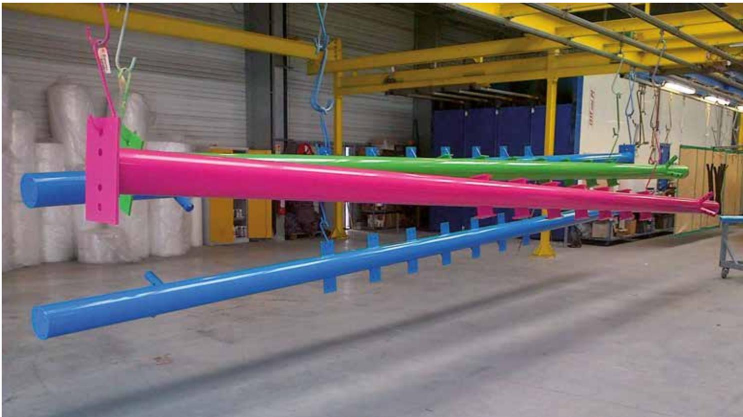
On appelle «laquage» l'application de peintures liquides. Cette application peut se faire de manière manuelle à l'aide de rouleaux, pinceaux, etc., ou de manière mécanique à l'aide d'un dispositif de projection. C'est cette dernière méthode qui est le plus couramment utilisée : à l'aide d'un pistolet, la peinture liquide est projetée sur la pièce à revêtir.
