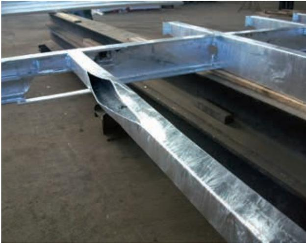
Figure 11 — Exemple de dégâts causés par une explosion de tube.
