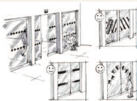
Schéma 24 : Signalisation visuelle des parties vitrées
