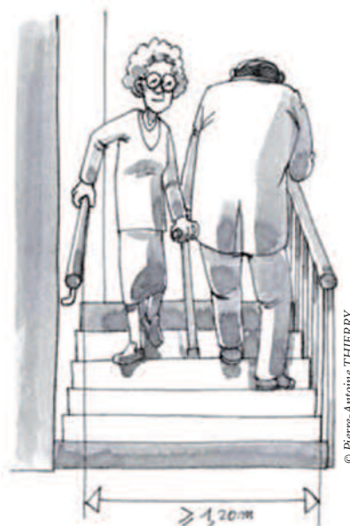
Schéma 9 : Exemple de largeur entre mains-courantes d'un escalier en ERP
