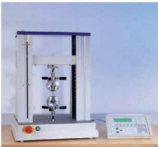
FIGURE 56 - EXEMPLE D'UN BANC DE TRACTION EN LABORATOIRE SERVANT AUX ESSAIS SUR ÉPROUVETTES NORMÉES
