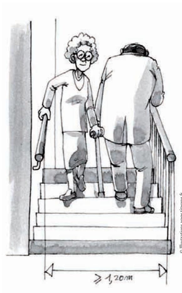
FIGURE 25 - LARGEUR DE PASSAGE EN ERP
