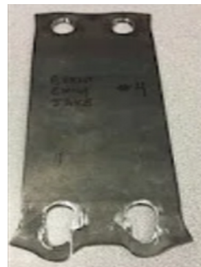
FIGURE 6.14 – Rupture par pression diamétrale
