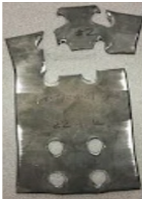
FIGURE 6.13 – Rupture par cisaillement de blocs
