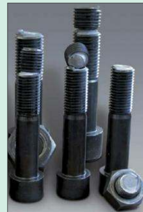
5.54-8 Echantillons après un test de fatigue
