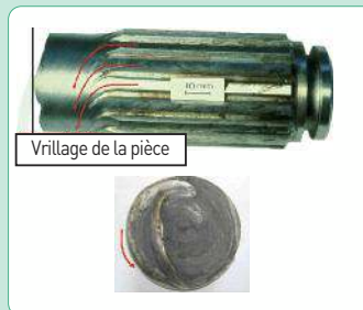
5.6-3 Rupture par sollicitation excessive de torsion
