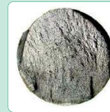
5.6-6 Rupture due à une fragilisation par l'hydrogène
