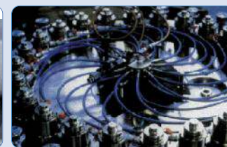
Serrage simultané par tendeurs individuels avec alimentation centralisée
