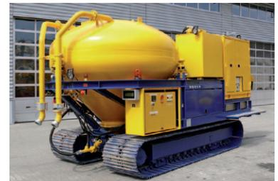
Navette type 1010 (fabrication Keller) pour soil mixing à sec
