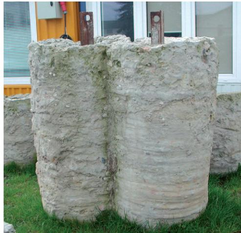
Colonnes DSM déterrées
