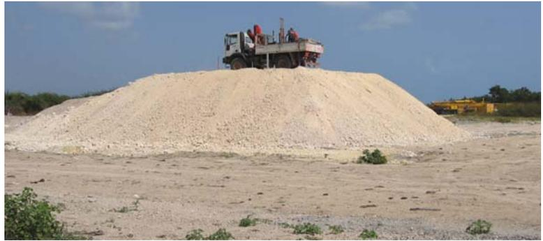
▲ Réalisation des CPTu sur le plot d'essai
