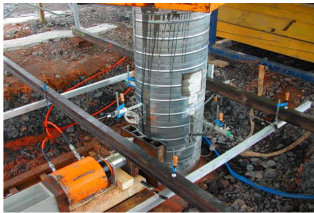
▲ Essai de chargement statique horizontal
