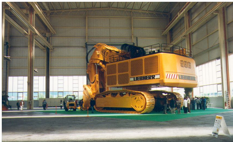
▲ Vue du radier traité par inclusions rigides type INSER ® sur lequel repose une pelle minière
