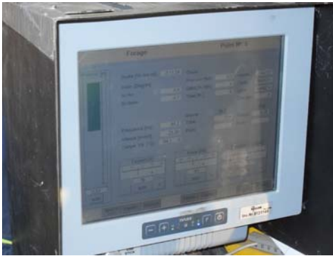
▲ Enregistreur de paramètres M5 dans la cabine de la foreuse
