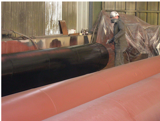
Figure 19 : application par pistolet pneumatique
