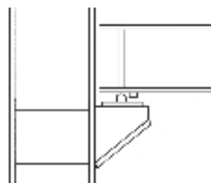
Appui simple à dilatation poutre sur poteau.
