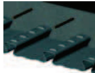
Bac acier collaborant de type Cofrastra avec un profil d'ondes en queue d'aronde crantées pour solidariser l'acier et le béton.
