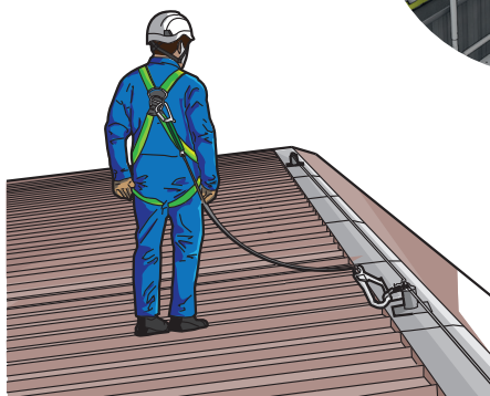
Ligne de vie (équipement permanent)
