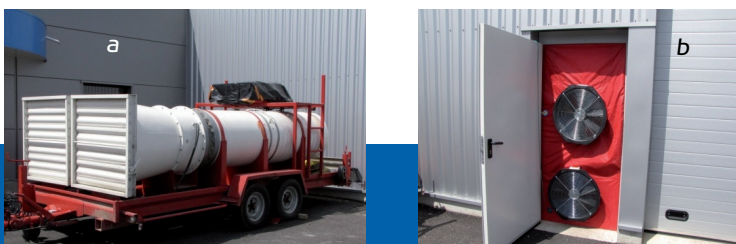
Équipements pour mesurer la perméabilité à l'air. (a) banc grand volume. (b) porte soufflante (blower door)
