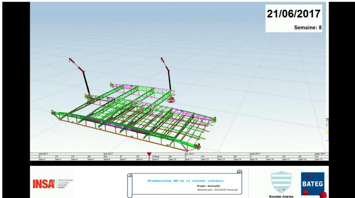
*Figure 26 : Assimilation du montage de la toiture centrale pour la date du 21 juin.*
