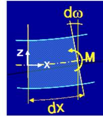
Donc la déformation principale est celle due à la flexion, ou encore, la variation de la rotation des sections  $d\omega_1$ . On montre que cette déformation de flexion est liée au moment de flexion par  $d\omega_1 = \frac{m_1}{EI} dx$ .
