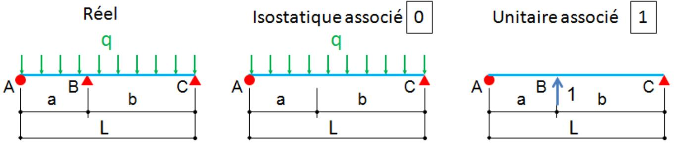
1/ Calculer les réactions d'appui du système unitaire 1
