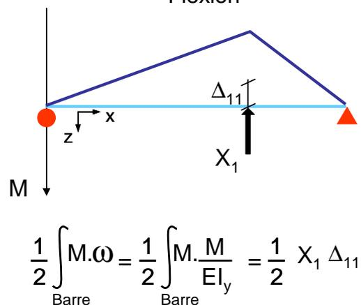
Lorsque  $E$ ,  $A$  et  $I_y$  sont constants le long d'une barre on calculera
