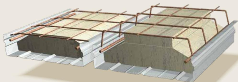
Cofradal® est un plancher composite destiné à tout type de construction. Sa légèreté et sa performance lui permettent de franchir de grandes portées. Cofradal® en version Décibel permet la réalisation d'un plafond acoustique en acier prélaqué.
