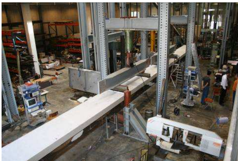
Figure 3 : Poutre Angelina™ de 17m de portée
