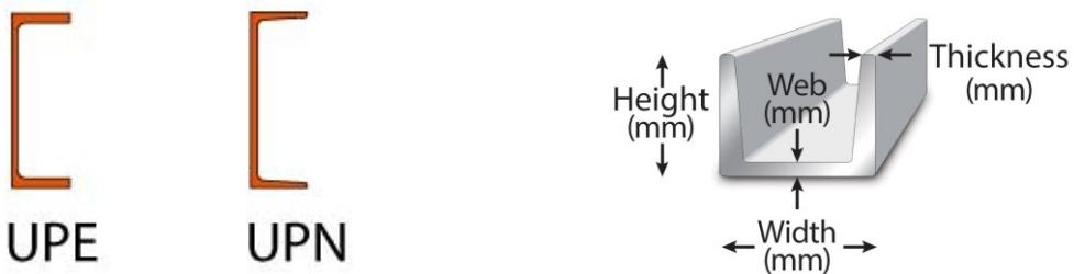
**UPE:** Fers U à ailes parallèles **Parallel Flange Channels** PFC Section
