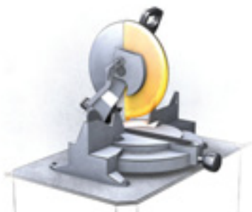
Protecteur réglable de scie à onglet à réglage automatique lors de la descente de lame
