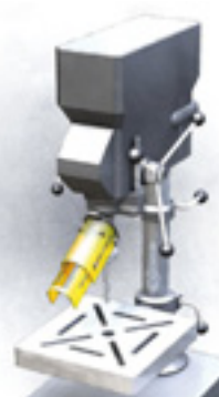
Protecteur réglable pour machine-outil (perceuse)
