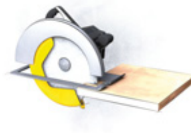
Protecteur réglable de scie circulaire portable à réglage automatique lors de l'avance de la lame
