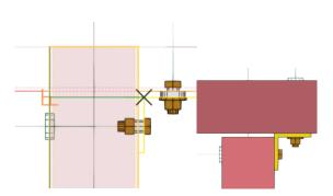
L'intérêt de cette coupe sera d'être présente en tant que contrainte à l'intérieur du composant personnalisé. Il ne sera pas nécessaire d'ajuster manuellement la position de l'extrémité du profil. En revanche il faudra veiller au bon croisement des profils au point d'épure, intersection des axes centraux de chaque profil.
