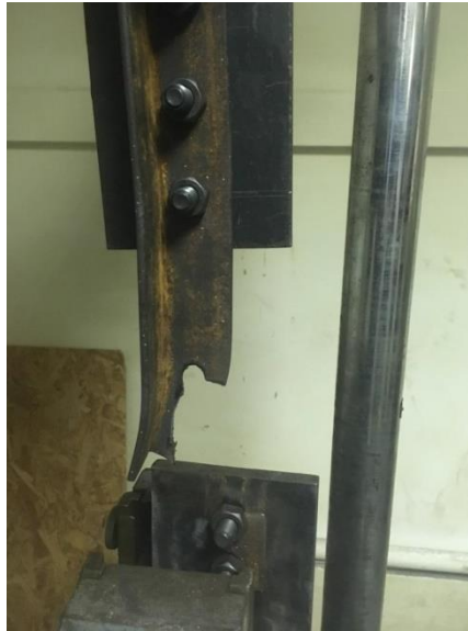
- Vue de l'éprouvette après rupture -
