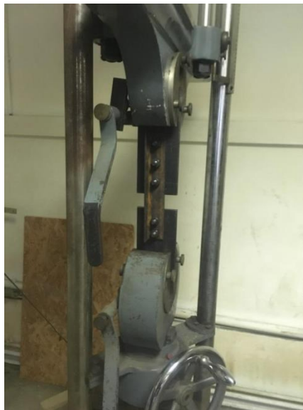
- Vue de l'éprouvette sur la machine de traction -
